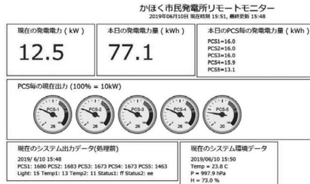
図 かほく市民発電所で自社開発した遠隔監視画面
