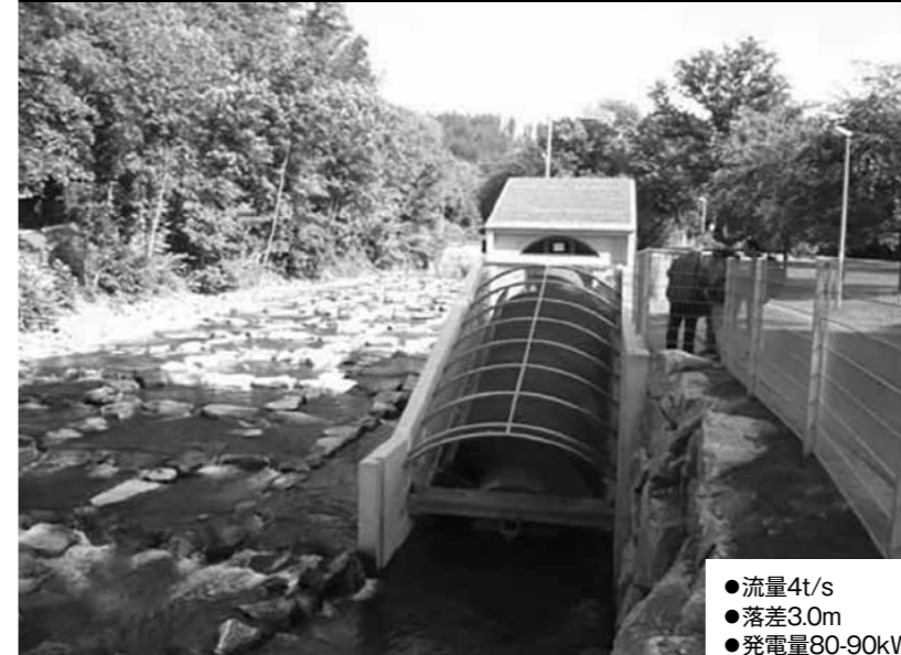
写真8 自然河川の中に設置されたらせん水車 (フライブルク市：ドライザム川)
